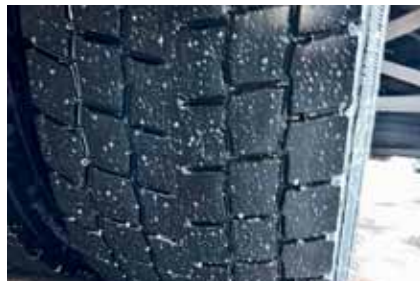
Износ протекторов шин ведущей оси TRD06 равномерный
