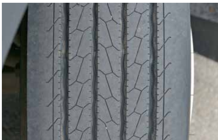
Рисунок протектора TRS02 представляет собой пять продольных блоков с множеством зигзагообразных ламелей
