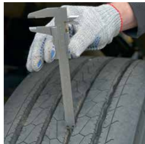
Остаточная высота рисунка протектора после 22 000 км составила 14,1 мм
