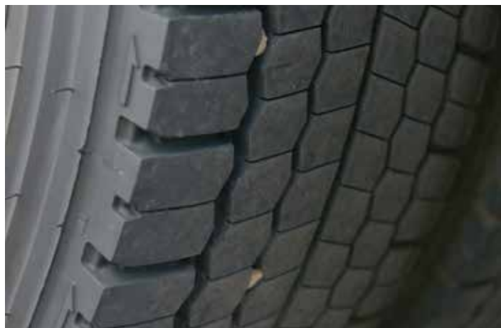
TRD02 отличается направленный рисунок с пятью продольными канавками. Продольные блоки разделены мелкими ламелями
