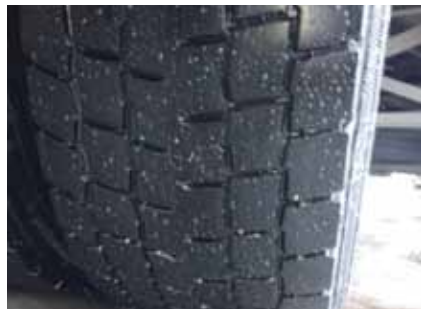
Износ протекторов шин ведущей оси TRD06 равномерный
