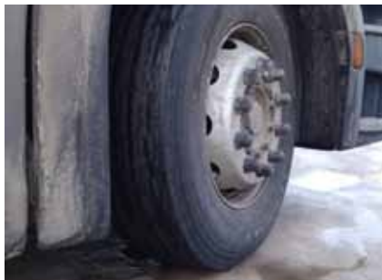
Ротацию шин TRS02 рулевой оси выполнили на пробеге 75 532 км
