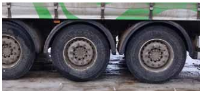
К смонтированным на осевые агрегаты шинам модели TRT02 замечаний нет. Износ их протекторов соответствует пробегу
