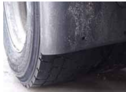
Нарезку протектора шин произвели на пробеге 80 000 километров
