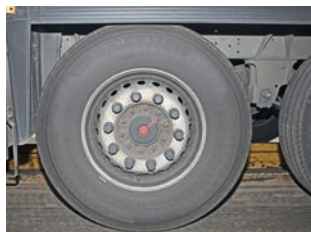
Давление в шинах полуприцепа поддерживается на уровне 8,5 бар
