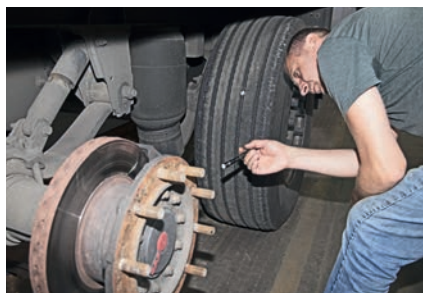
Дежурный механик сервисного центра проверил состояние подвески и тормозных узлов участвующего в спецпроекте полуприцепа
