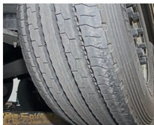
Износ протекторов всех шин равномерный
