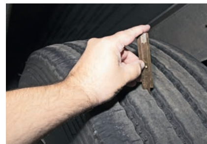
Оценку остаточной глубины протектора проводили механическим измерителем. В зависимости от оси, показания составили от 12 до 14 мм
