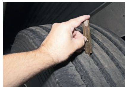
Оценку остаточной глубины протектора проводили механическим измерителем. При пробеге 102 000 км запас составлял более 10 мм
