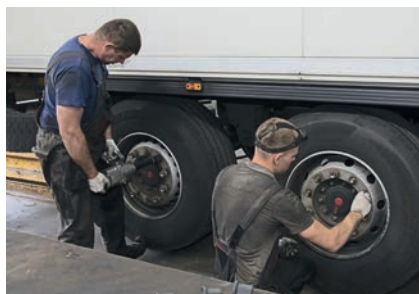
Для нивелирования износа протекторов шин, установленных на разных осях полуприцепа, выполнили перестановку колес на пробеге около 70 000 км
