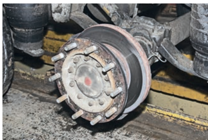
Перед установкой шин проверили ходовую часть прицепа и ступичные подшипники. Замечаний нет
